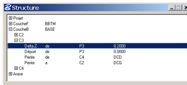
La fenêtre de structure liste, ligne par ligne, et point par point les contraintes de positionnement.
